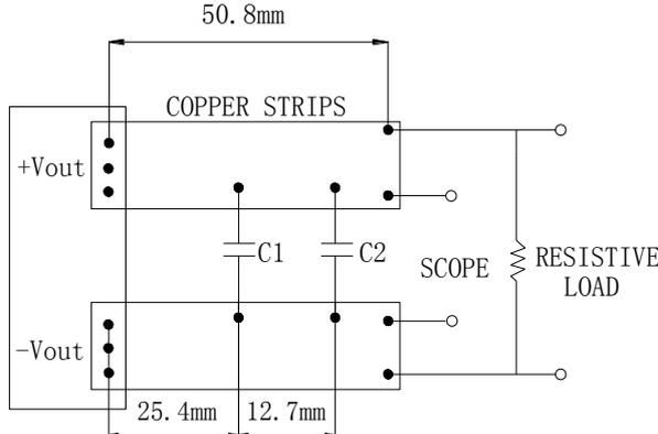
图(13) 输出纹波测试示意图
