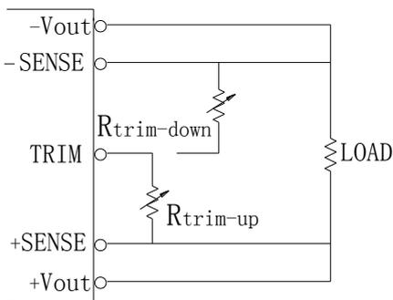
图(14) 输出电压调节示意图
