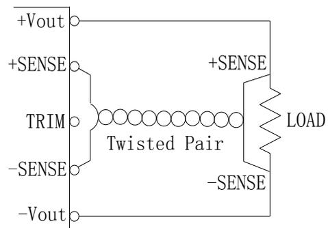
图(15) 输出电压远端补偿电路
